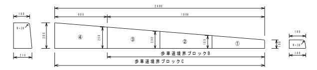
・歩車道境界ブロック落し(自転車乗り入れ用) (重量 3本落とし:139kg, 4本落とし:211kg)
